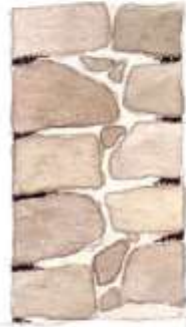
Joints fins affleurant le parement.
