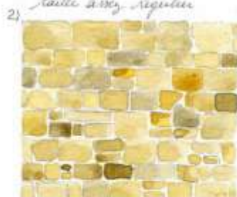
appareillage en moellons assez régulier
