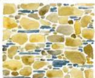
appareillage de moellons de granite et pierre de schiste, non assisés.
