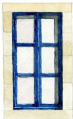
Fenêtre à 2 vantaux, 6 carreaux, en bois peint.
