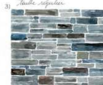
appareillage en pierre de schiste assisée.
