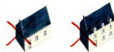
Pignon recouvert d'ardoises.
