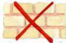
La couleur du joint ne s'accorde pas avec celle de la pierre.
